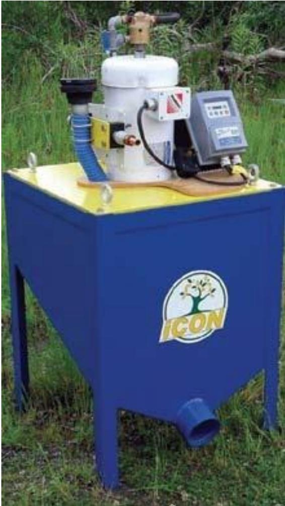
***Est conçue pour traiter jusqu'à 2 tonnes de minerai à l'heure.
