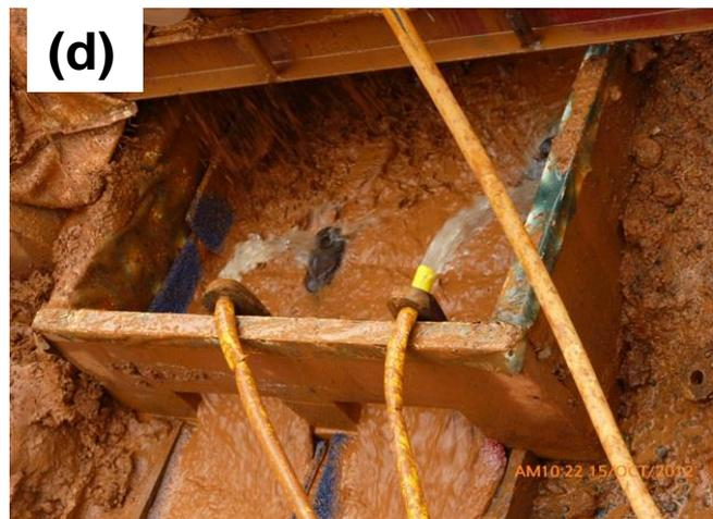
**Planche 1 :** (a) : Site de stockage de terres en provenance de terrain d'exploitation. Les terres sont convoyées par des véhicules type KIA. (b) Mise de terres dans les machines concasseuses pour les broyer finement (c) Pompe hydraulique installée à proximité d'un cours d'eau (d) Lavage des poudres de terres par des eaux mises en pression .
