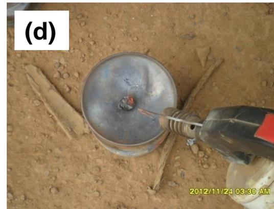
**(a)** Ajout du mercure au minerai concentré et amalgamation du minerai brut, **(b)** le mercure qui contient l'or est soigneusement séparé du minerai concentré par lavage à la battée, **(c)** le mélange mercure-or est filtré à travers une pièce de tissu afin de séparer le mercure liquide résiduel, **(d)** l'amalgame est chauffé pour évaporer le mercure, ce qui produit l'or spongieux (texture poreuse)
