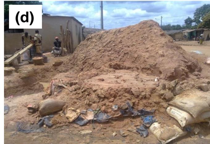
**(a)** Moulin à minerais **(b)** Tas de minerais broyés au moulin **(c)** Lavage de minerais sur *Sluices* (ou table de lavage) **(d)** Tas de stériles stockés en ville après lavage
